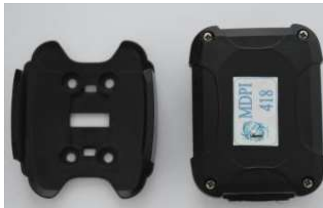
Gambar 3. Bagian belakang Spot Trace . Kiri: Braket penyangga, kanan: nomor aset MDPI.
