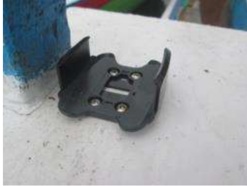
Gambar 6. Braket Spot Trace dipasang pada kapal.
