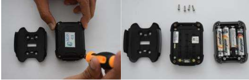
Gambar 5. Membuka alat (kiri). Alat terbuka dengan baterai terpasang (kanan).
