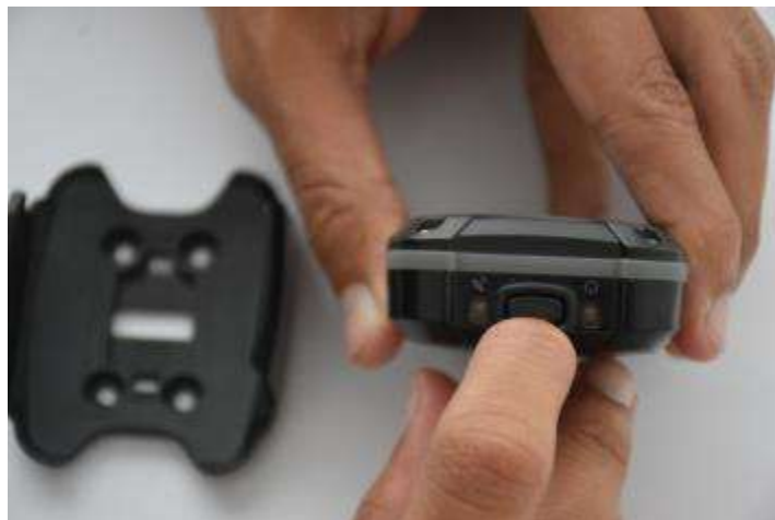
Gambar 7. Menekan tombol power untuk menyalakan dan mematikan alat.
